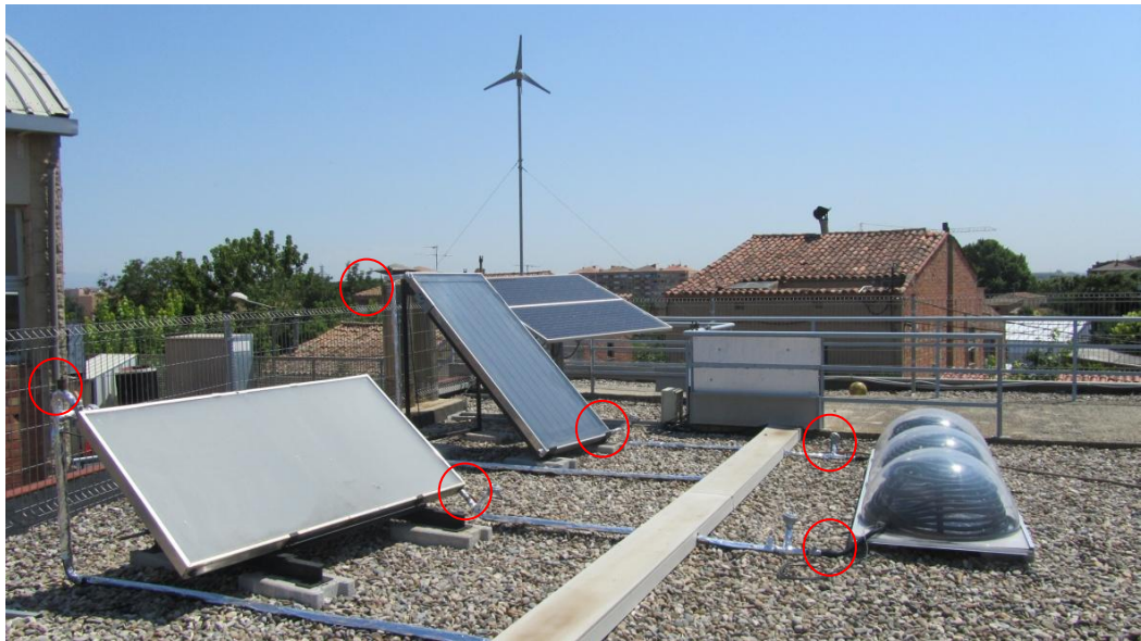
Imatge 73. Fotografia de l'aula d'energies renovables. En vermell, les sondes de temperatura.
