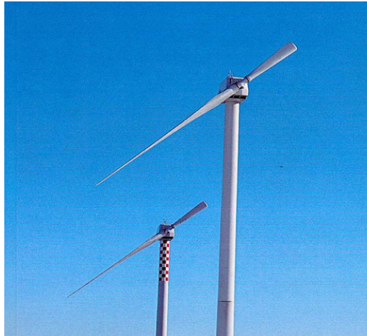
Imatge 41. Fotografia de dues aeroturbines monopala.
