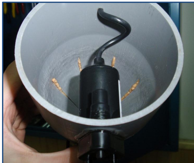
Imatge 62: Bomba que absorbirà l'aigua de fora i l'expulsarà als dipòsits
