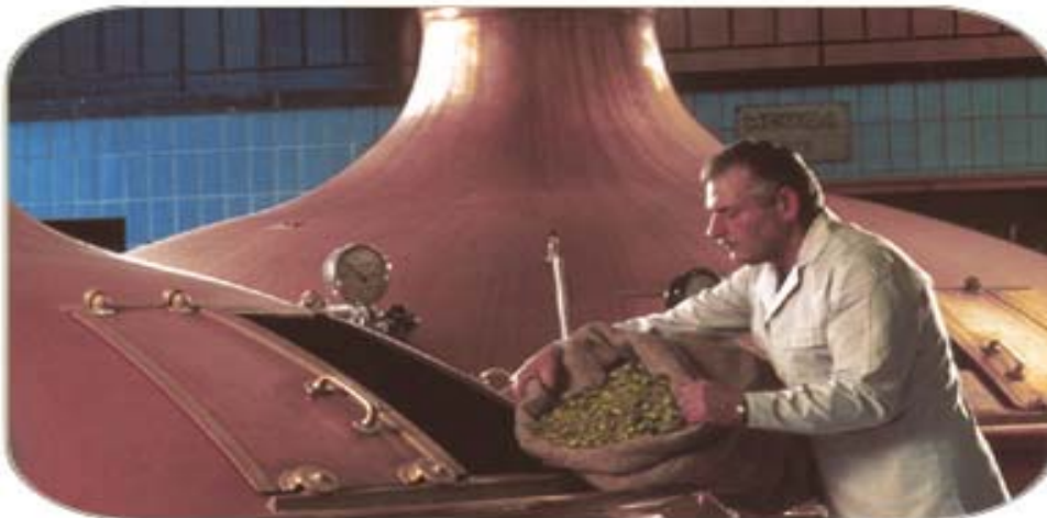
Caldera tradicional de coure que encara es pot veure a moltes instal·lacions de cervesa. En el moment que s'afegeix el llúpol a la barreja
