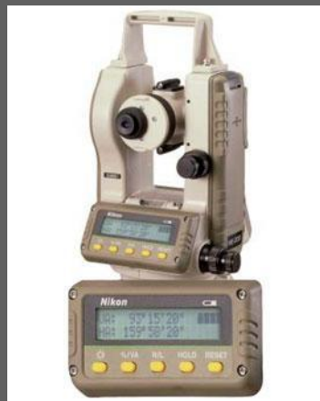
Teodolit, 1900. Teodolit, instrument per mesurar angles amb finalitats pròpiament topogràfiques. Teodolit electrònic, NIKON NE-202
