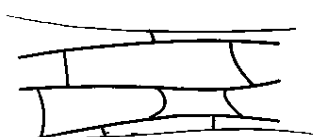
elastòmers: cadenes enllaçades entre si amb possibilitat de desplaçament reversible
