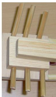
Després ens tocava fer la carrosseria del motor, teníem tot un pal que feia 6 mm. Ø i havíem de tallar-lo en sis parts iguals que havien de fer 45 mm.
