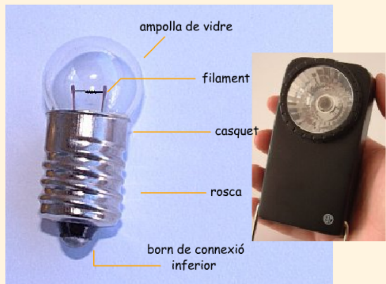
Parts d'una bombeta de llanterna de 3-6 V
