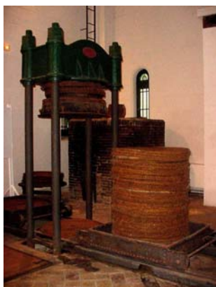
Prensa hidràulica amb les estores on es premsava la massa.
