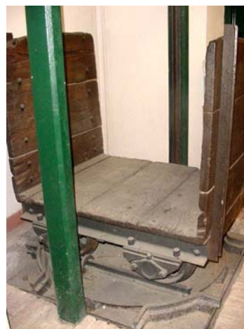
Vagoneta des d'on es pujaven les olives a la planta superior
