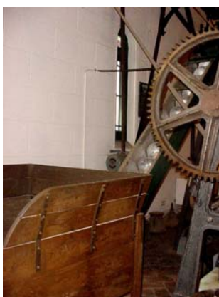
Detall de la zona del bisenfí, per on es pujaven les olives a la trituratora.
