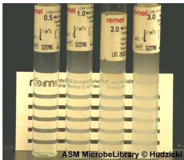
Fig. 1. Imatge de diferents concentracions de l'escala McFarland
