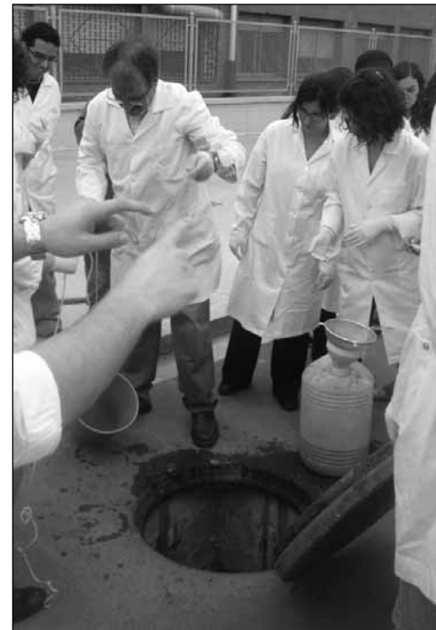
••• AGAFANT MOSTRES D'AIGÜES RESIDUALS AL COL·LECTOR DE RAMBLA MARINA PER FER EL JAR-TEST.
