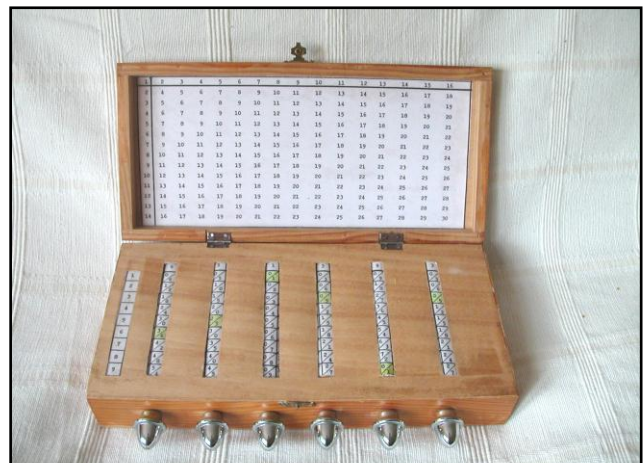
Exemplar de la màquina multiplicadora de Neper fabricat per un alumne de l'IES El Sui de Cardedeu en un treball de recerca
