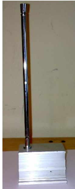
Imatge 11.- Gnòmon d'altura variable.
