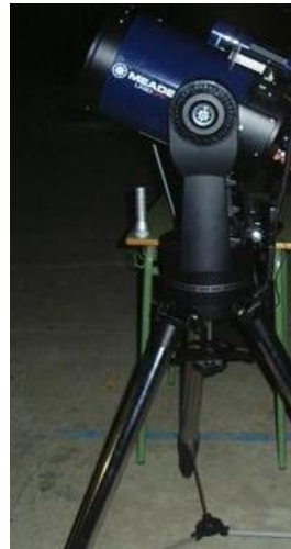
Imatge 54.- Telescopi Meade LX90GPS de 8" i 2m de distància focal.
