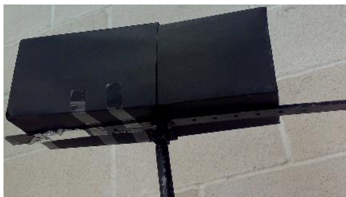
Imatge 166.- Muntatge correcte de la cambra fosca a l'extrem d'una muntura.
