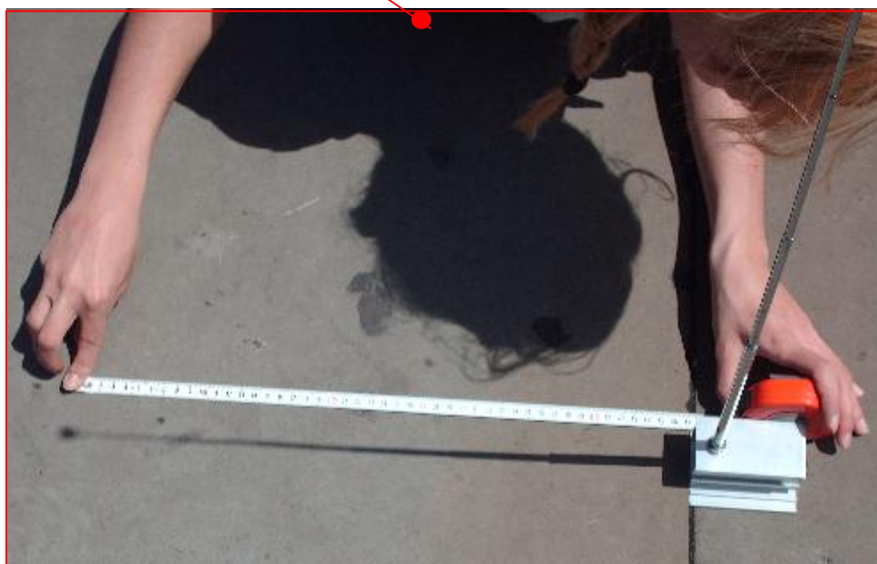
Imatge 15.- Mesura de l'ombra projectada pel gnòmon a Londres
