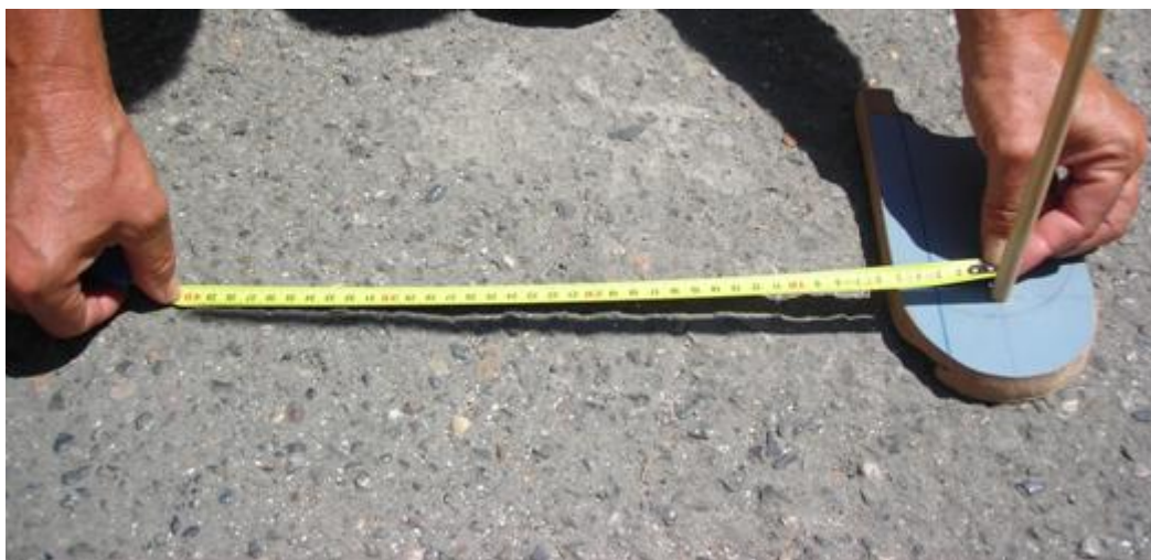
Imatge 13.- Mesura de l'ombra projectada pel gnòmon a Lleida.
