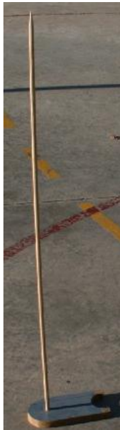
Imatge 10.- Gnòmon d'altura coneguda (100cm)
