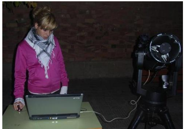
Imatge 128.- Jo (Laura Latorre) duent a terme la captació d'imatges des de l'ordinador amb la "webcam LPI" connectada al focus primari del telescopi Meade LX90GPS.
