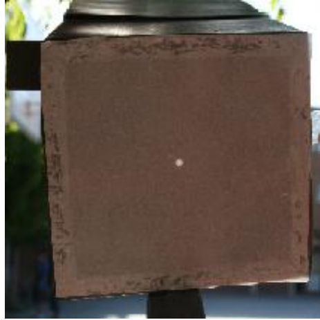
Imatge 31.- Imatge obtinguda utilitzant com a diafragma l'orifici creat clavant una xinxeta.
