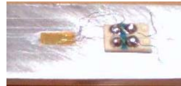
Figura 38. Galga extensomètrica fixada a la làmina
