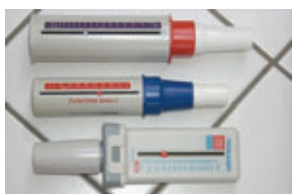
Peak flow: aparell per mesurar la capacitat pulmonar
