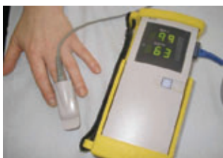
Pulsioxímetre Aparell per mesurar la saturació d'oxigen a la sang
