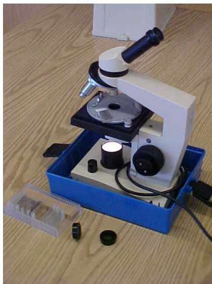
Posant els polaritzadors al microscopi biològic es converteix en microscopi petrogràfic
