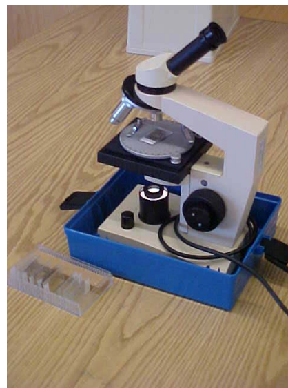
Posant els polaritzadors al microscopi biològic es converteix en microscopi petrogràfic
