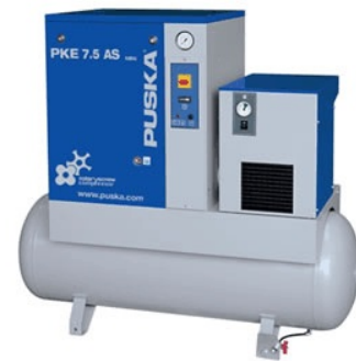
Dipòsit i compresor de cargols Puska PKE 10bar i 600l/min Motor elèctric amb connexió estrellatriangle. Manteniment cada 2000h i canvi d'oli i filtre cada 4000h
