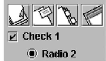
Exemple de visualització d'un JButton amb icones gràfiques, un JCheckBox i un JRadioButton (de dalt a baix). Noteu la diferència en l'aspecte dels dos darrers.
