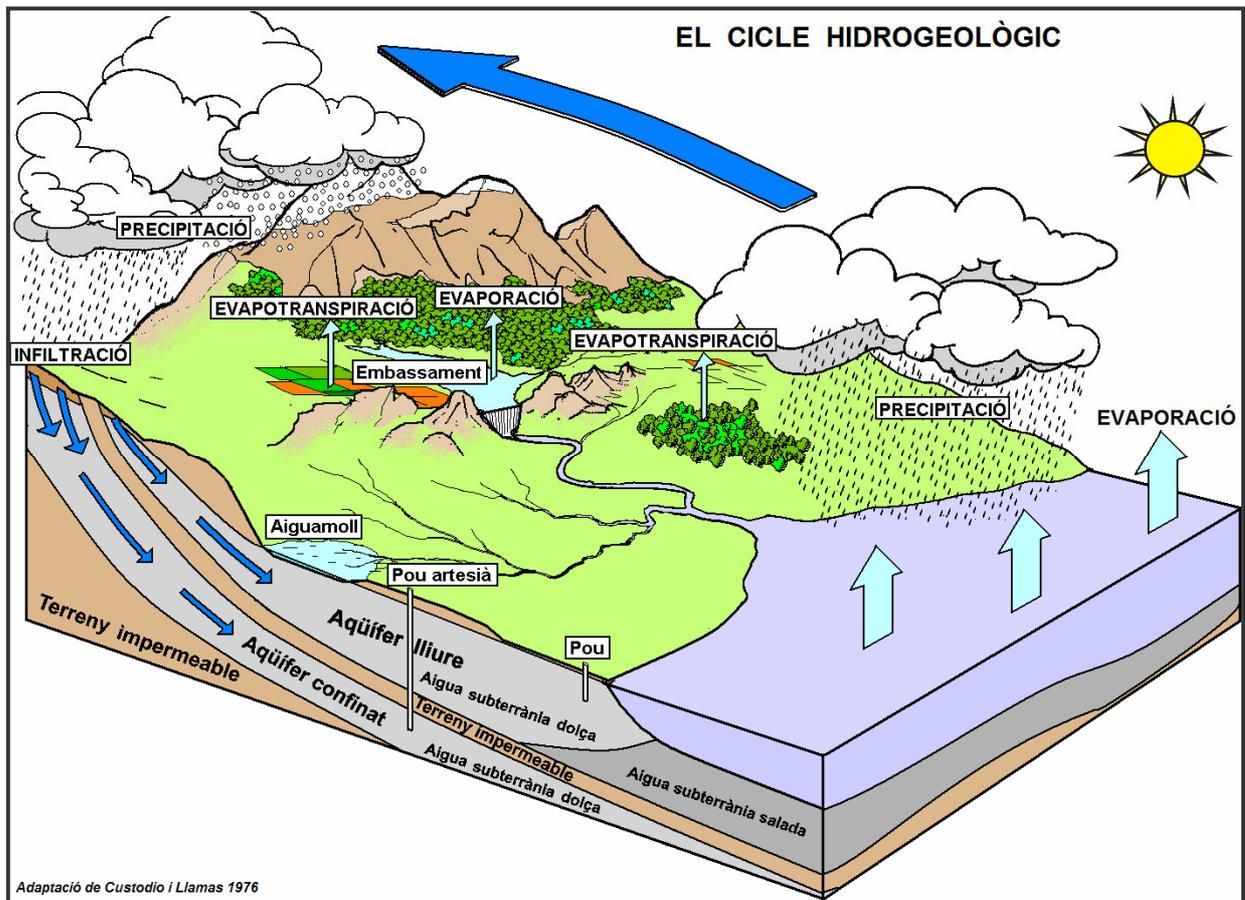
Com es pot veure, al nostre planeta l'aigua segueix un cicle natural, part del qual transcorren sota terra. L'energia que mou el cicle hidrològic és la del Sol, que produeix l'evaporació de l'aigua, tota la resta del cicle transcorre arrossegat només per la gravetat.
