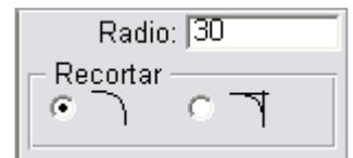
Se introduce en la ventana que aparece al efecto el radio del arco a crear y si el empalme debe borrar o no la parte sobrante de la unión.
