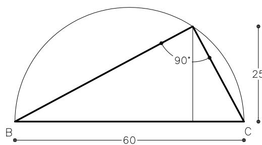
El procediment utilitza l'arc capaç de  $90^\circ$  del segment BC
