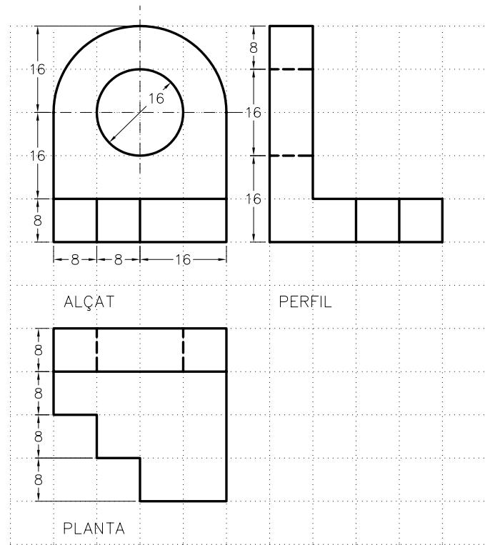
Donada la representació axonomètrica d'un cos, dibuixe a la mateixa escala les vistes dièdriques de planta, alçat i perfil. Després acoteu-les (utilitzeu un estil d'acotació propi), les mides són en mil·límetres. Tingueu en compte que totes les mesures són múltiples de la unitat de la quadrícula dibuixada.
