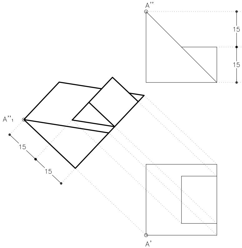
Apliqueu un canvi de pla horitzontal a la figura per tal que la nova projecció del punt A sigui A'<sub>1</sub> i dibuixeu únicament les arestes vistes.
