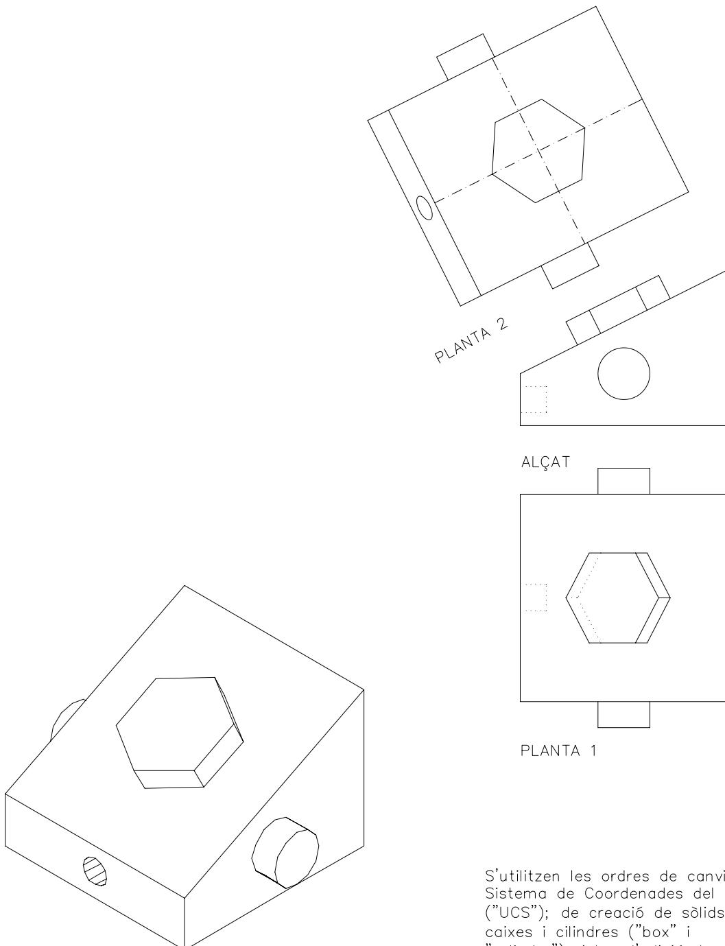
S'utilitzen les ordres de canvi de Sistema de Coordenades del Usuari ("UCS"); de creació de sòlids: caixes i cilindres ("box" i "cylinder"); i les d'edició de sòlids: tall, suma i resta de sòlids ("slice", "union" i "subtract").
