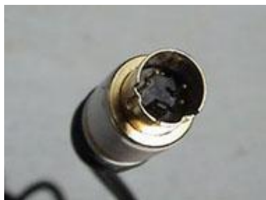
Imagen de los pines de un conector PS/2, donde podemos apreciar lo finos que son.
