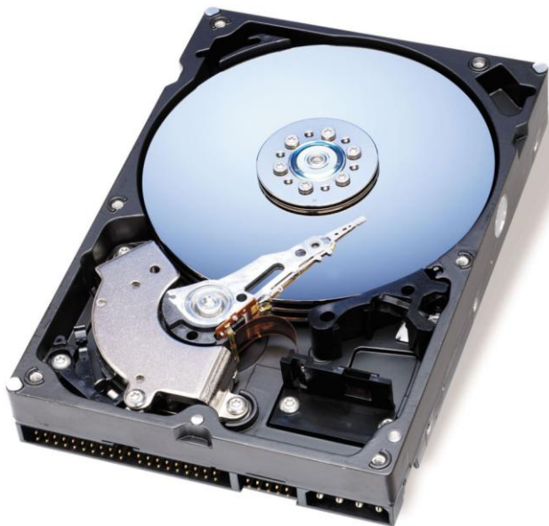
Figura 6. Aspecte interior d'un disc dur
