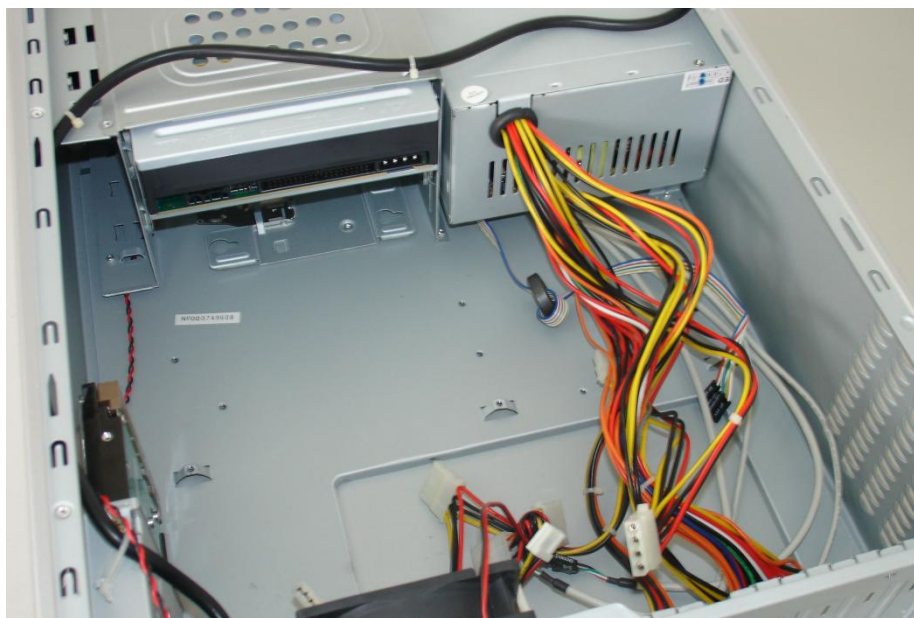
Figura 5. Font d'alimentació integrada a la caixa de l'ordinador
